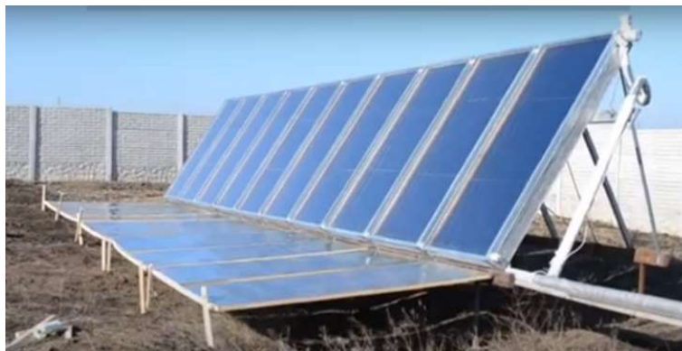
Рис. 1. Сонячний колектор з відбивачем сонячних променів.
