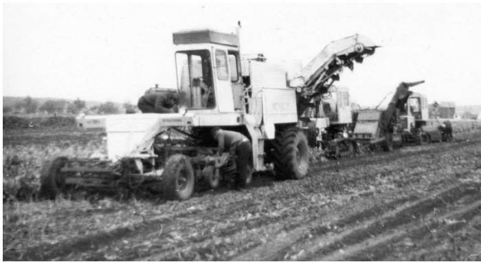
Рис. 4. Експериментальний комплекс 8-рядних збиральних машин: самохідна коренезбиральна; причіпна гичкозбиральна; причіпний доочищувач головок коренеплодів (зліва), викопувально-очисні робочі органи типу “підкопувальна лапа – сферичний диск – турбіна-очищувач” (справа)
