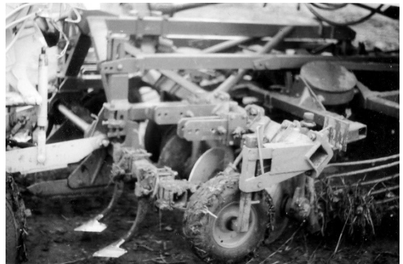
Рис. 4. Експериментальний комплекс 8-рядних збиральних машин: самохідна коренезбиральна; причіпна гичкозбиральна; причіпний доочищувач головок коренеплодів (зліва), викопувально-очисні робочі органи типу “підкопувальна лапа – сферичний диск – турбіна-очищувач” (справа)
