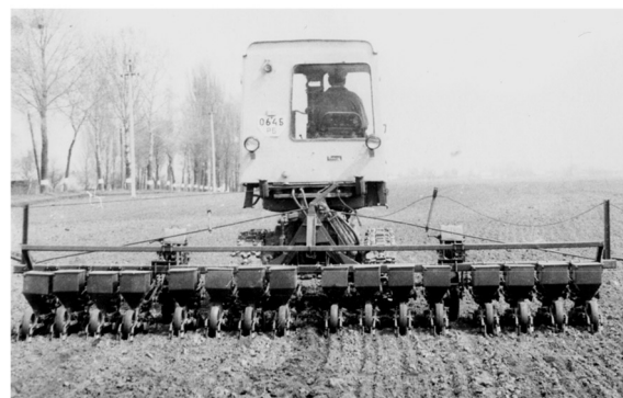
Рис. 1. Схема переобладнання сівалки ССТ 12Б у 16-рядну (зліва), сівалка в роботі (справа)
