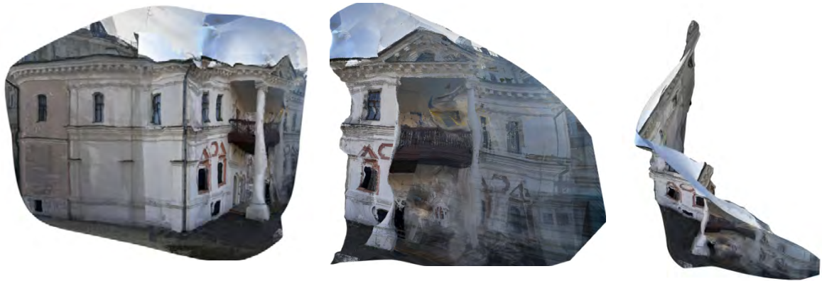
Рис. 3. Дефекти моделі цифрової копії
